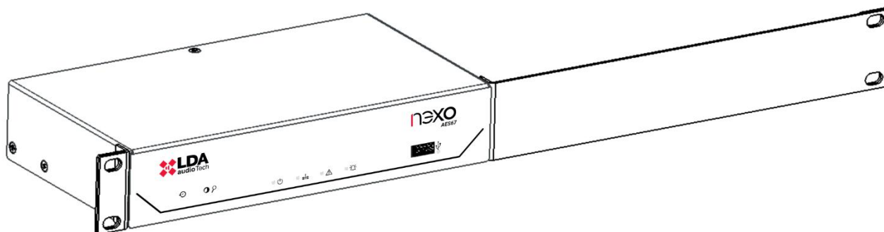
Ilustración 17: Vista delantera montaje en rack de un dispositivo
