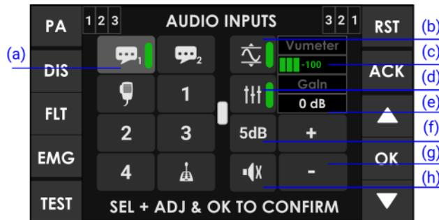
Ilustración 53: Ventana ajuste de entradas de audio
