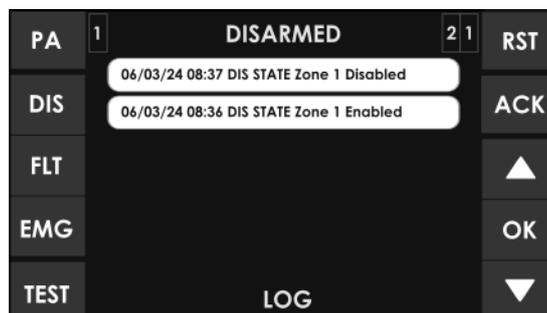
Ilustración 47: Ventana registro desactivación
