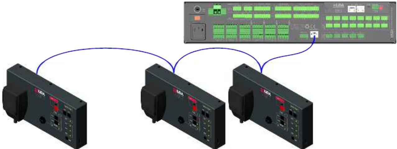
Ilustración 9: Conexión al Sistema de Evacuación por Voz
