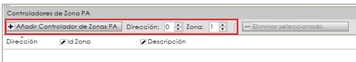
**NOTA:** Las direcciones físicas de 0 a 7 corresponden con las 8 posibles configuraciones del interruptor que puedes seleccionar en el VCC-64. Vea el manual de usuario del dispositivo VCC-64 para más información, disponible en [LDA Soporte Web](#).
