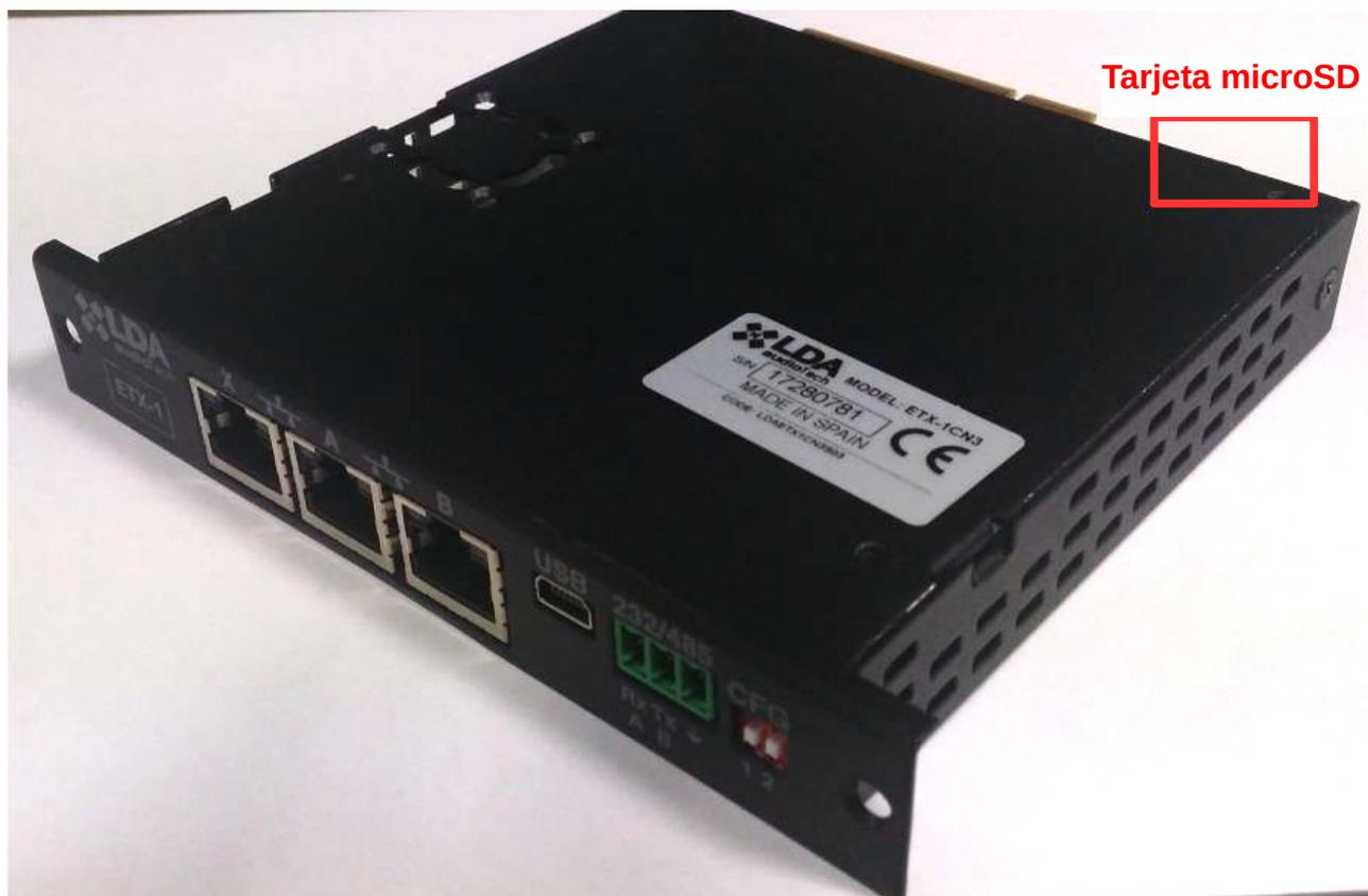
Ilustración 3: Tarjeta microSD del módulo ETX
