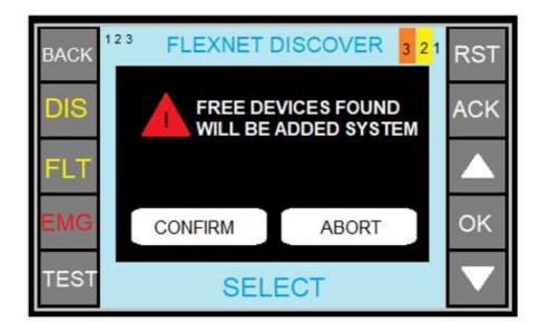
5. NEO-8060 realizará la búsqueda pertinente y enlazará los equipos que estén correctamente conectados en el loop.
