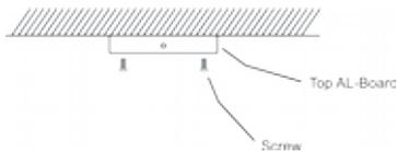
3. Alinee y deslice el altavoz por la pieza de fijación de aluminio y luego ajuste los tornillos con la llave hexagonal.
