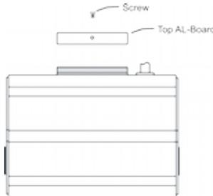
2. Asegure con tornillos la pieza de fijación de aluminio al techo o a la pared.
