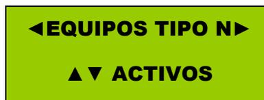
La característica de los equipos de tipo N consiste que el Asc-82N se comunica con ellos y con los otros equipo no hará dicha comunicación. Cuando los micrófonos que se conecten al ASC-82N sean de la serie X (MCA-1X y MCA-8X) no se pueden poner en la entrada de micrófono primera sino a partir de la segunda dejando libre dicha entrada.
