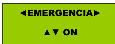
La prioridad del estado de emergencia para ocupar el canal es en primer lugar mensajes de voz emitidos por los micrófonos y después la secuencia de evacuación, por lo que si hay o se esta lanzando la secuencia de evacuación y un micrófono pide la palabra, el equipo conmutara al micrófono, después de haber terminado el micrófono de hablar volverá a dar paso la secuencia de emergencia.
