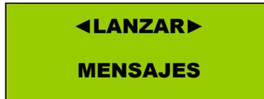
Solo se pondrá lanzar un mensaje a la vez, es decir, si se lanza el mensaje 1 y luego se lanza otro mensaje, el primero se para y el que se ha lanzado después se activa. También se para el mensaje si se lanza la emergencia.
