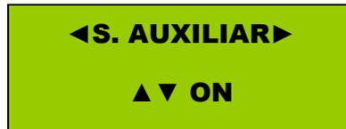
Si en este estado hay alguna de las dos entradas de micrófono (la entrada 6 y 7) configurada como entrada de CD se le dará paso. Si un micrófono que tiene mas prioridad que la entrada de CD pide palabra este conmutará y dará paso al micrófono y una vez terminado de hablar, se volverá a la entrada de CD.
