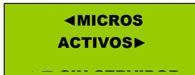
En el modo sin servidor, el equipo se mantiene en estado de reposo hasta que algún micrófono solicite la palabra. En este momento el ASC-82N conmuta automáticamente a sistema auxiliar y permite el lanzamiento del mensaje. Si por el contrario se configura en modo solo S. auxiliar, el equipo no atenderá a la petición de los micrófonos cuando el servidor del sistema no este conectado. Por defecto esta configurado en modo sin servidor.
