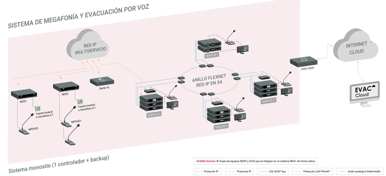
···· Protocolo IP Protocolo IP ---- LDA ACSI® bus Protocolo LDA Flexnet® —— Audio analógico balanceado Cableado de audio con malla Cableado UTP estándar Cableado fibra Cableado UTP estándar Cableado UTP estándar
